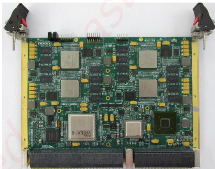
图 2-8 运动控制卡 MC\_4DSP\_VPX 实物图
