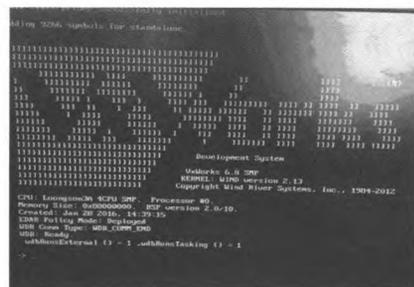
图7 龙芯3A在VxWorks系统下运行示意图
