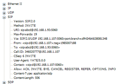
图 6-3 SIP 软电话接收到 INVITE 消息 图 6-4 SIP 软电话向网关侧发送 100 回复
