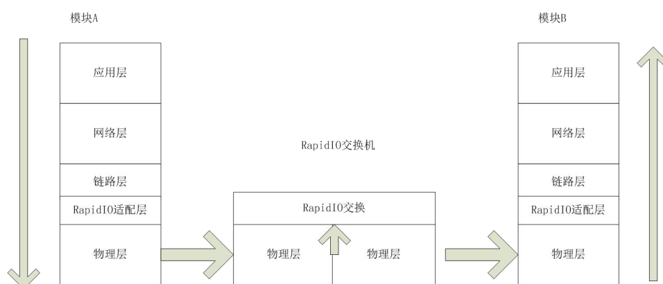
图 4-5 本系统内部模块消息通信
