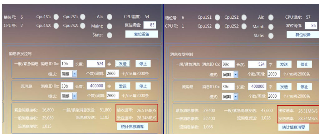
图 5-13 FC Over RapidIO 同板两 CPU 通信测试结果
